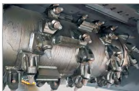
Tambour à pic horizontal (source Placo)
