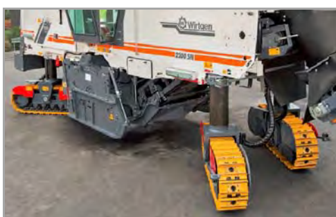
Quatre chenilles et tambour à position centrale (source Placo)
